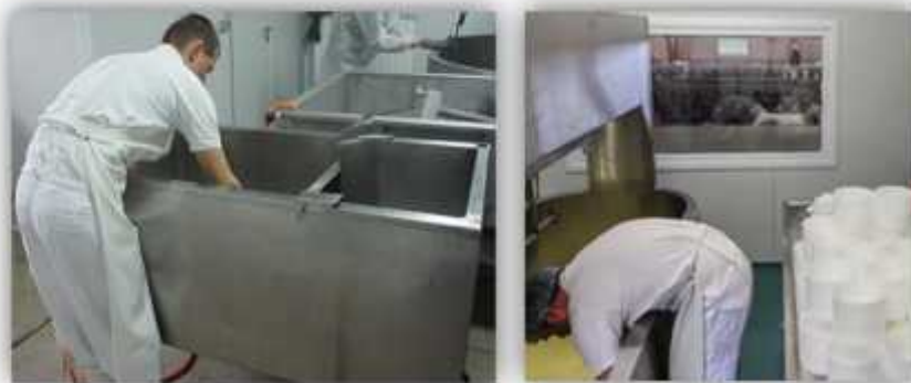
Extracción de cuajada desde el fondo de cuba manual y mecanizada
