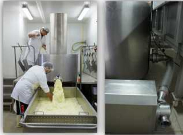
Cuba elevada y bomba de trasiego de cuajada
