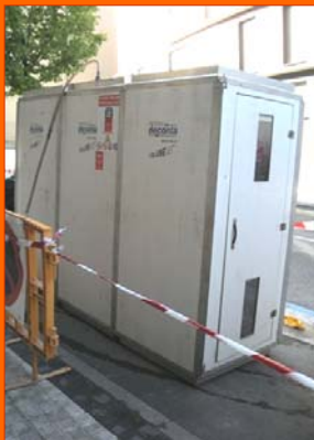
Unidad de descontaminación de tres compartimentos
