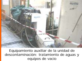
Equipamiento auxiliar de la unidad de descontaminación: tratamiento de aguas y equipos de vacío
